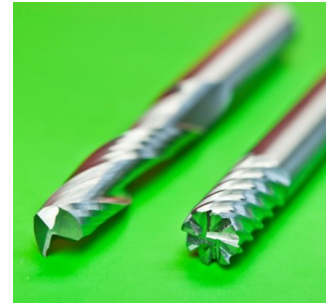
Werkzeuge aus nanoskaligen Hartmetall (Geschliffen von Fisch-Tools, Österreich) (2).
